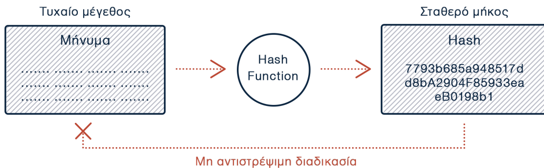
Σχήμα 2.1: Λειτουργία συνάρτησης κατακερματισμού
