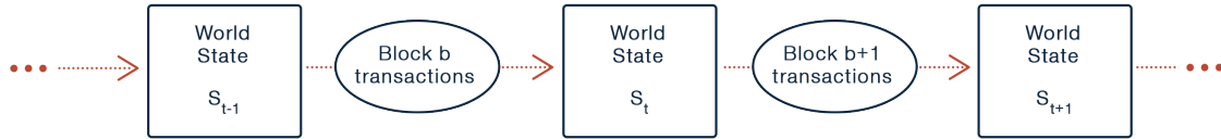
Σχήμα 2.7: Blockchain ως μηχανή καταστάσεων
