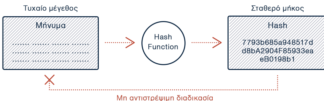
Σχήμα 2.1: Λειτουργία συνάρτησης κατακερματισμού
