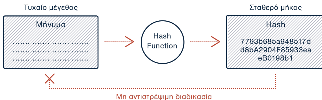
Σχήμα 2.1: Λειτουργία συνάρτησης κατακερματισμού
