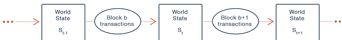
Σχήμα 2.8: Blockchain ως μηχανή καταστάσεων
