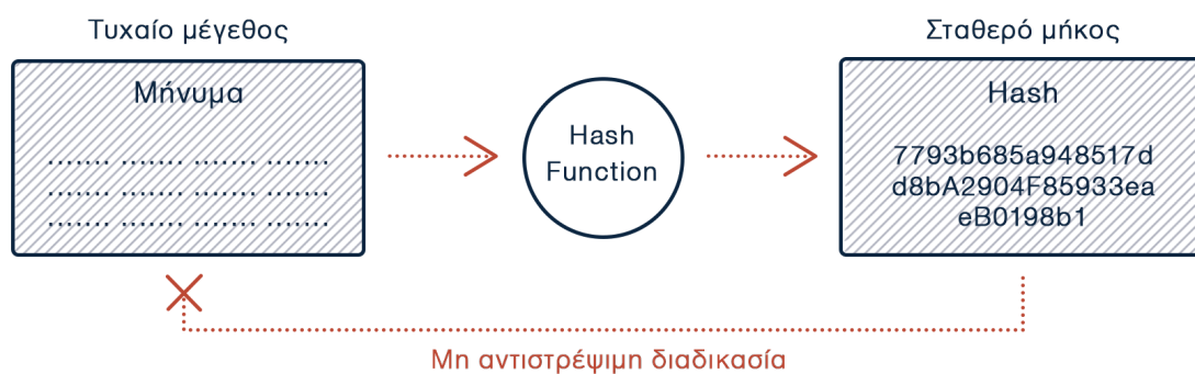
Σχήμα 2.1: Λειτουργία συνάρτησης κατακερματισμού
