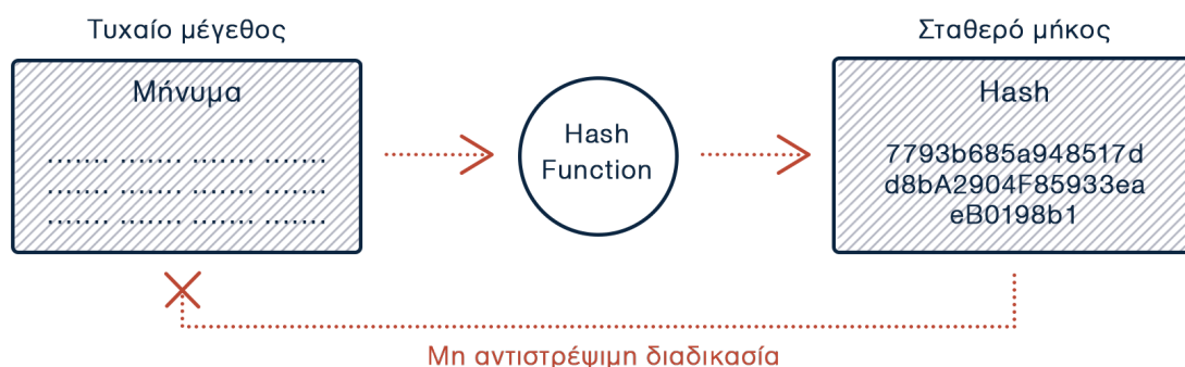
Σχήμα 2.1: Λειτουργία συνάρτησης κατακερματισμού
