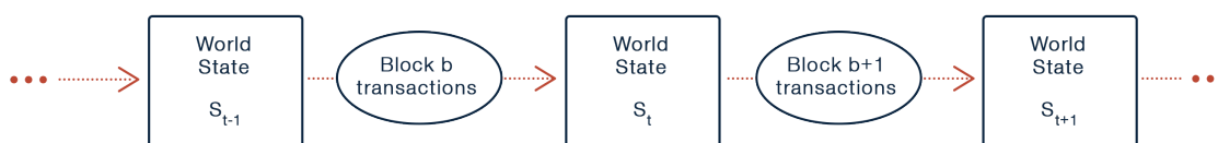
Σχήμα 2.8: Blockchain ως μηχανή καταστάσεων
