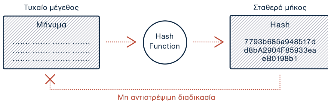
Σχήμα 2.1: Λειτουργία συνάρτησης κατακερματισμού
