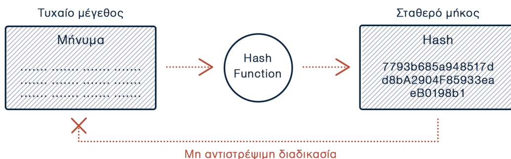
Σχήμα 2.1: Λειτουργία συνάρτησης κατακερματισμού
