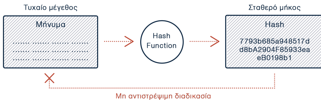
Σχήμα 2.1: Λειτουργία συνάρτησης κατακερματισμού
