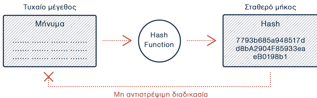
Σχήμα 2.1: Λειτουργία συνάρτησης κατακερματισμού
