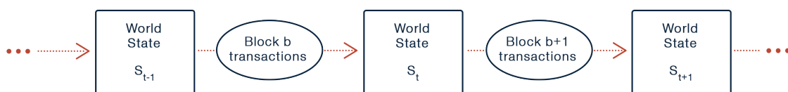
Σχήμα 2.8: Blockchain ως μηχανή καταστάσεων
