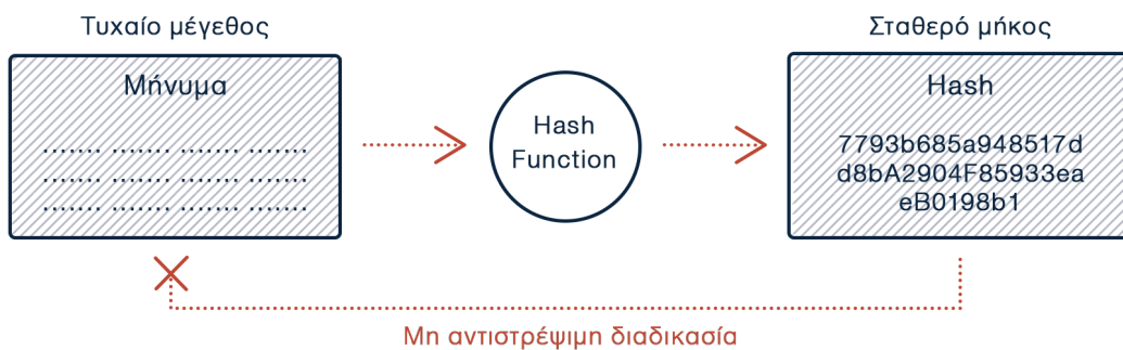
Σχήμα 2.1: Λειτουργία συνάρτησης κατακερματισμού
