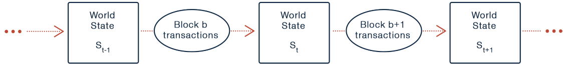
Σχήμα 2.7: Blockchain ως μηχανή καταστάσεων
