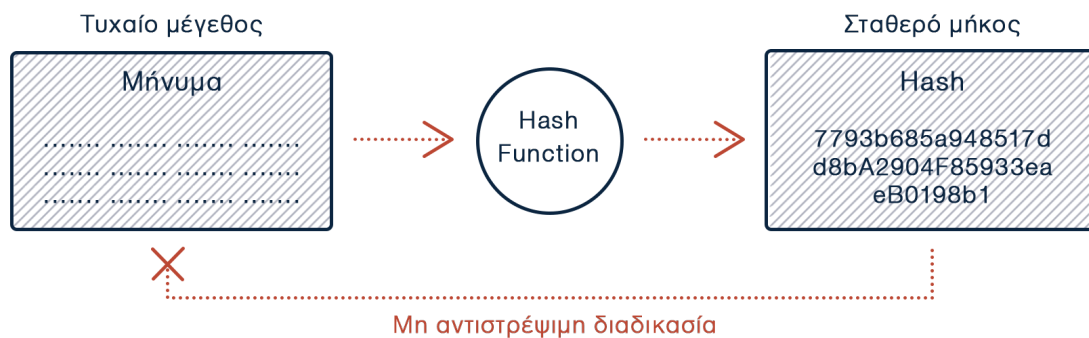
Σχήμα 2.1: Λειτουργία συνάρτησης κατακερματισμού
