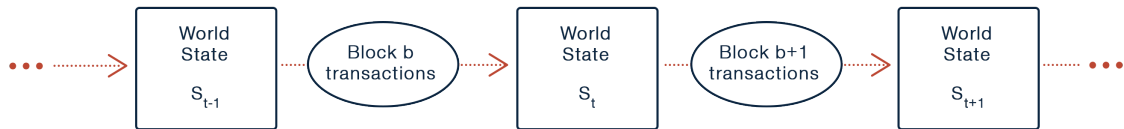
Σχήμα 2.7: Blockchain ως μηχανή καταστάσεων
