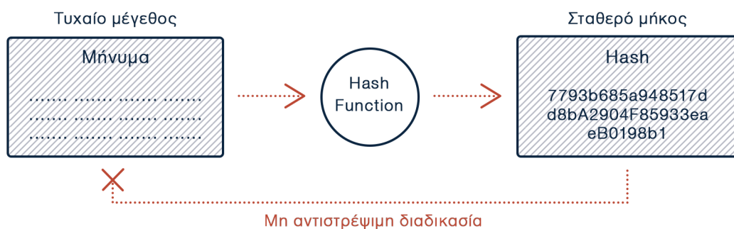
Σχήμα 2.1: Λειτουργία συνάρτησης κατακερματισμού
