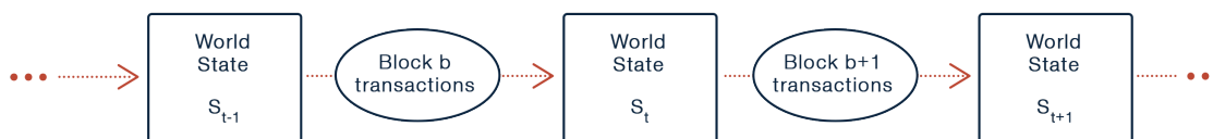
Σχήμα 2.8: Blockchain ως μηχανή καταστάσεων
